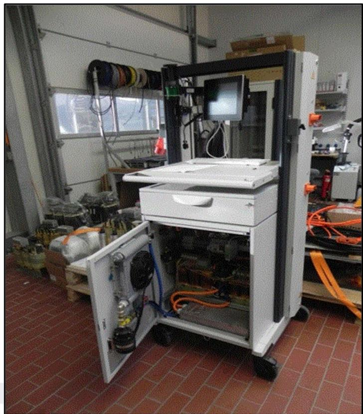
Bild 11: HV Arbeitsplatz für SoC und Balancing (Quelle: ZDK)
