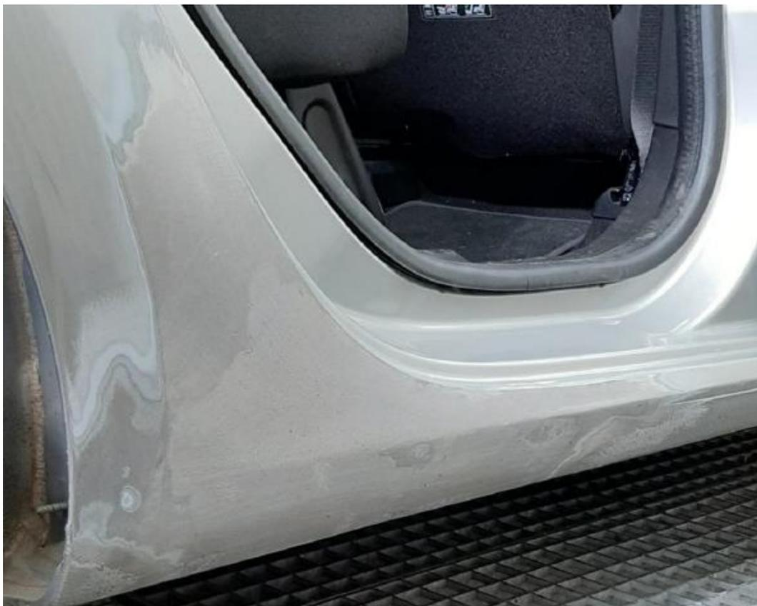
*Abbildung 4: Definierter Übergabezustand wurde nach Schleifen der 2K-Epoxidharz-Karosseriefüllmasse erreicht.*
