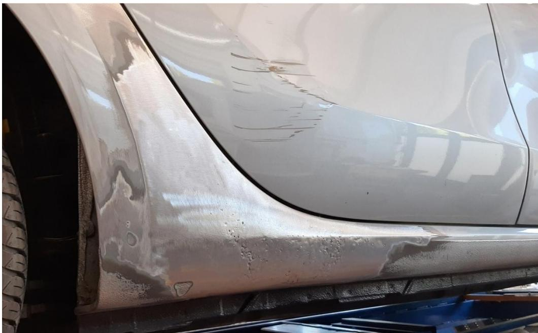
Abbildung 2: Schweller / Kniestück nach erfolgter Blech-Instandsetzung und vor Auftrag von 2K-Epoxidharz-Karosseriefüllmasse.
