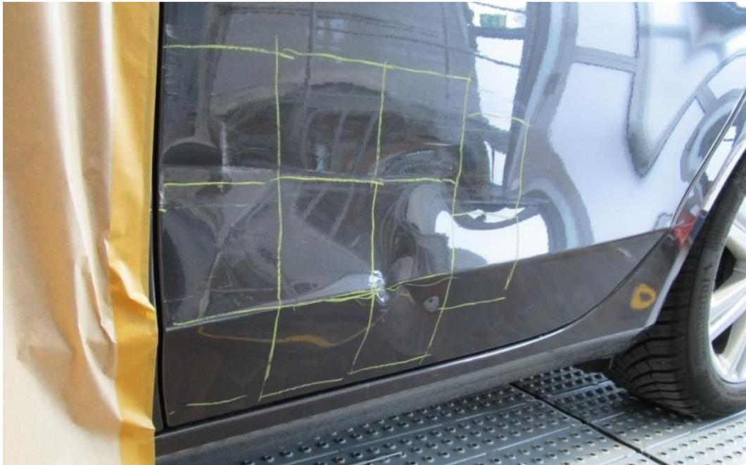
Abbildung 10: Ausmaß der Beschädigung vor Instandsetzungsbeginn – Bsp. 4.
