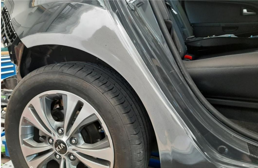
Abbildung 7: Definierter Übergabezustand wurde nach Schleifen der 2K-Epoxidharz-Karosseriefüllmasse erreicht.
