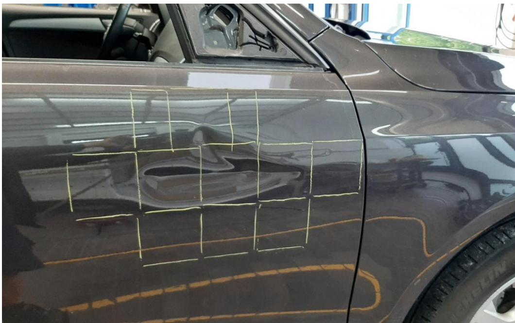
Abbildung 8: Ausmaß der Beschädigung vor Instandsetzungsbeginn – Bsp. 3.
