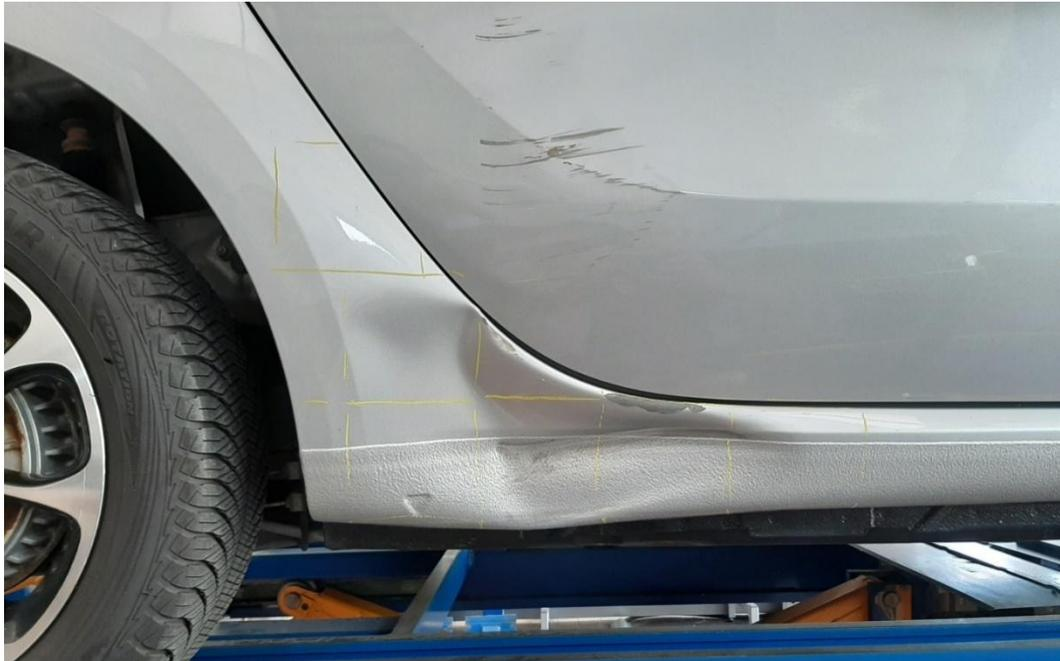
Abbildung 1: Ausmaß der Beschädigung vor Instandsetzungsbeginn – Bsp. 1.
