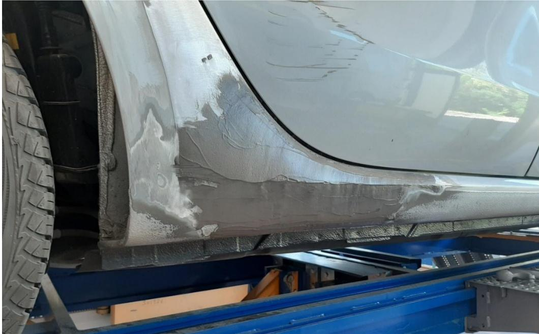
*Abbildung 3: Schweller / Kniestück nach Auftrag von 2K-Epoxidharz-Karosseriefüllmasse.*
