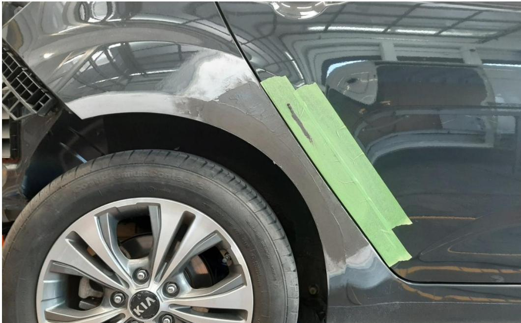
Abbildung 6: Auftrag von 2K-Epoxidharz-Karosseriefüllmasse nach erfolgter Blech-Instandsetzung.
