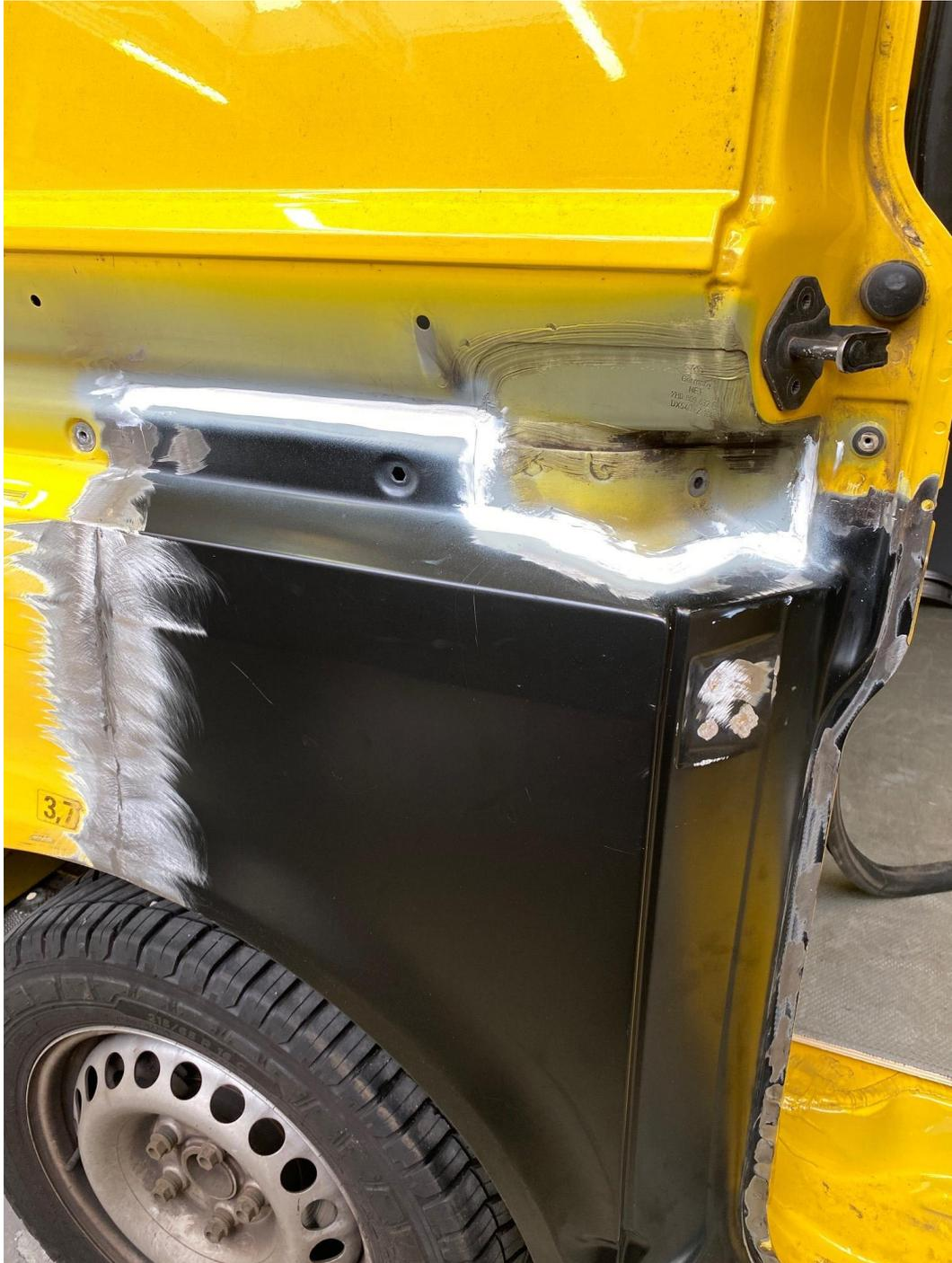
*Abbildung 21: Nicht erreichter Übergabezustand auf Grund von ungleichmäßigem Übergangsbereich und hohe Rautiefe durch fehlenden Endschliff.
